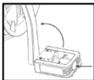
3. Abra el acople rápido de la abrazadera del sillín y gradúe la altura introduciendo el mismo hasta el límite mínimo. Cierre nuevamente el acople rápido asegurando el sillín.
