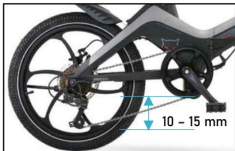
Verifique la tensión de la cadena, presionando la cadena hacia abajo, sin que el desviador (1) se mueva. Esta no debe de moverse más de 10 a 15 milímetros (mm).
