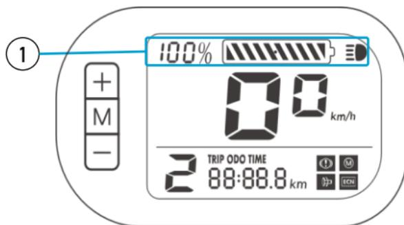
No agote la batería hasta su carga mínima permitida, cuando el indicador de carga del tablero y de la batería esté en 10% cargue inmediatamente.
