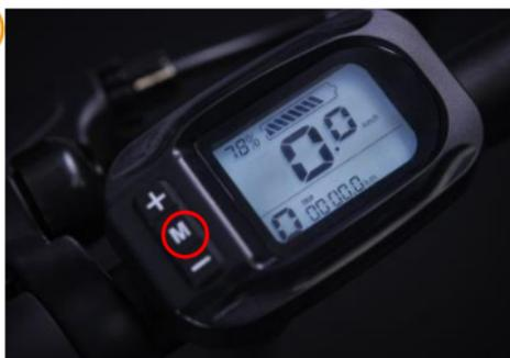
C. Girar el acelerador nuevamente para verificar que la velocidad este en menos de 7 km/h.
