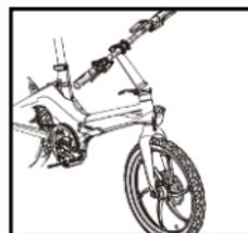
5. Tire del seguro hacia arriba de manera que se libere el pin de seguridad (1) y posteriormente tire de la manija del acople rápido para abrirla y pliegue el chasis, dejando que éste se pliegue hacia el lado de la bisagra. Retenga el chasis para que no se vaya a golpear mientras este plegándolo.
