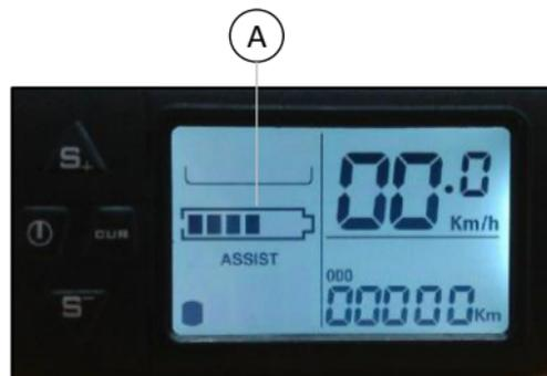
No agote la batería hasta su carga mínima permitida, cuando el indicador de carga del tablero y de la batería esté en el nivel mínimo de batería (barra inferior) cargue inmediatamente.
