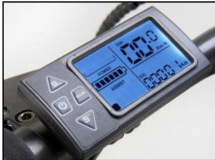
Asegúrese de que el suiche de la batería está en la posición "ON" para poder encender el comando de control.
