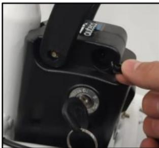
2. A continuación, conecte el enchufe de entrada de energía del cargador a la toma de corriente (110 V / 60 Hz), una vez hecho esto la carga se iniciará.
