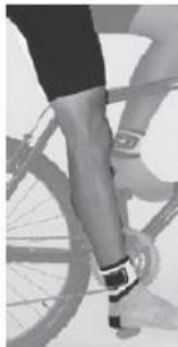
4. Coloque el talón en el pedal inferior, ajuste la altura del sillín hasta que éste suba hasta su entrepierna y la pierna quede completamente recta.
