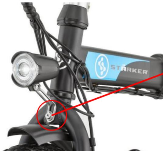
Insertar soporte de la farola y platina de guardabarro por el tornillo y asegurarlo a la horquilla de la bicicleta con la tuerca M6
