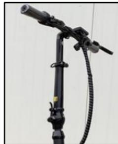
5. Tire de la manija del acople rápido para abrirla, posteriormente presione hacia arriba la manija de modo que se libere el pin de seguridad y pliegue el chasis, dejando que éste se pliegue hacia el lado de la bisagra. Retenga el chasis para que no se vaya a golpear mientras este plegándolo.
