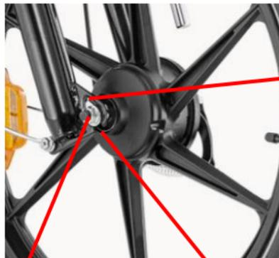
Montar la llanta garantizando que la horquilla repose sobre el pin de posicionamiento
