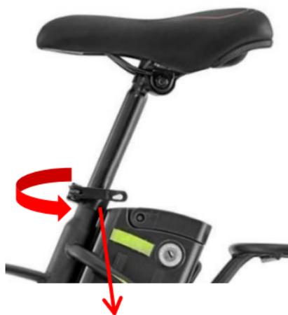
Asegurar el sillín con la palanca de sujeción
