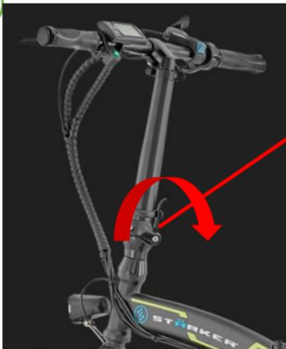
Halar la palanca hacia abajo y apretar tornillo a tope con la llave hexagonal #6mm
