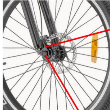
Montar la llanta delantera asegurando la arandela en el orificio que se encuentra en la horquilla
