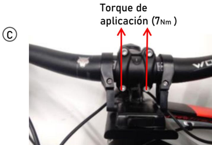
D. Ubicar el velocímetro de modo que el protector del puerto USB no quede atascado en ningún punto.
