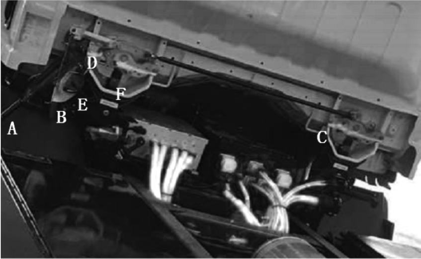
A – Palanca, B – Palanca limitadora, C – gancho auxiliar de seguridad, D – Gancho principal de seguridad, E – soporte inferior de gancho de seguridad, F – Gancho de seguridad
