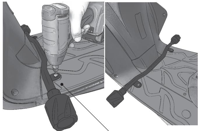
UBIQUE EL SLIDER ALINEANDO LOS BUJES CON LOS ORIFICIOS LA MOTO, LUEGO INTRODUZCA LOS 2 TORNILLOS DE MODO QUE PASEN POR EL SLIDER Y EL BUJE.
