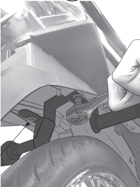
UBIQUE EL SLIDER E INSTALE CON LOS MISMOS TORNILLOS, APLICANDO LA MISMA FUERA EN AMBOS.
