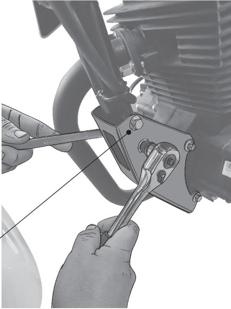
RETIRE LOS 2 TORNILLOS SOSTENIENDO LA TUERCA DE SEGURIDAD.
