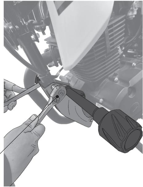
UBIQUE LOS DOS SLIDERS Y PASE LOS TORNILLOS POR AMBAS PLATINAS DE CADA UNO DE LOS SLIDERS.
