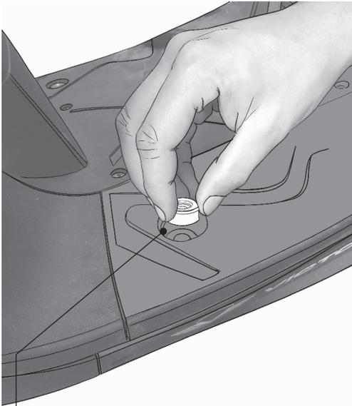
POSICIONE LOS 2 BUJES EN LOS ORIFICIOS DE LOS TORNILLOS QUE SE ACABAN DE RETIRAR.
