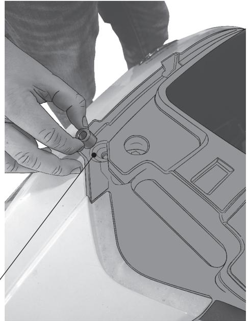
POSICIONE LOS 4 BUJES EN LOS ORIFICIOS DE LOS TORNILLOS QUE SE ACABAN DE RETIRAR.
