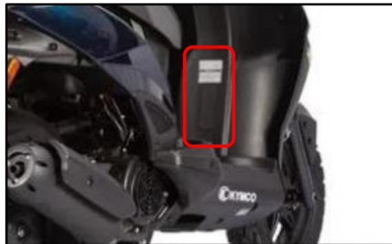
El número del chasis (VIN) está en el chasis en la parte inferior del cabezote de la dirección. Para acceder a este retire la tapa plástica rectangular ubicada en la carcasa que cubre el cabezote de dirección, tal cual como se muestra en el imagen.
