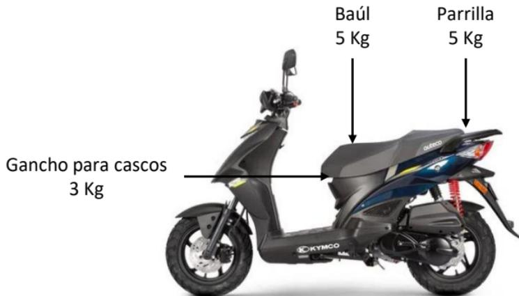
El comportamiento del vehículo varía en función de la carga transportada y de la disposición de esta. Una sobrecarga afecta la estabilidad, direccionalidad y seguridad del vehículo.
