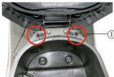
Con el asiento hacia arriba, coloque el anillo de retención del casco en el poste. Baje y presione hacia abajo el asiento para bloquearlo y asegurar el casco en su lugar. Para quitar el casco, abra el asiento.
