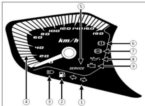
**1. INDICADOR DE DIRECCIONALES:** Este testigo parpadeará cuando se activan las luces direccionales.
