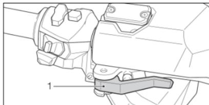
Gire la palanca a la izquierda hasta que oiga el clic de bloqueo. Para desbloquearla, gire la palanca a su posición original (a la derecha).
