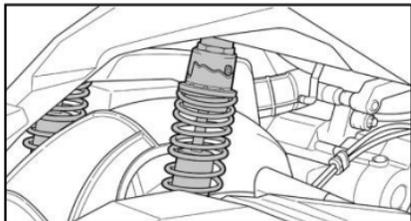
Para aumentar la precarga y endurecer la suspensión, utiliza las posiciones de la 3 a la 5. Para disminuir la precarga y hacer la suspensión más blanda, usa la posición 1. Asegúrate de ajustar ambos amortiguadores en las mismas posiciones de precarga. La posición de precarga estándar es: 3.
