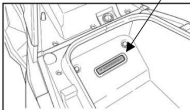
El número del chasis (VIN) está en el bastidor y se puede ver en la parte interior del baúl.
