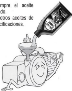
Al drenar el aceite para cambiarlo, el motor debe estar caliente.
