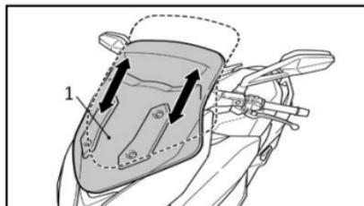
Presiona ligeramente la palanca de ajuste de la posición del parabrisas (2) hacia delante con la mano derecha. Sujete el parabrisas desde su posición media inferior y empujelo con la mano izquierda hacia arriba o hacia abajo para ajustar la altura del parabrisas como desee. Suelte la palanca de ajuste de la posición del parabrisas y compruebe que el parabrisas ha quedado bien fijado en su posición.
