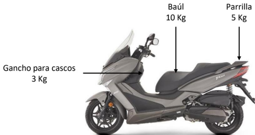
El comportamiento del vehículo varía en función de la carga transportada y de la disposición de esta. Una sobrecarga afecta la estabilidad, direccionalidad y seguridad del vehículo.
