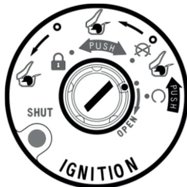
**Precaución:** Después de bloquear el interruptor de encendido, gire el manillar suavemente para confirmar que la dirección esté bloqueada.
