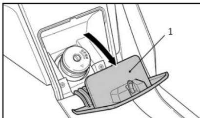
Gire el suiche de encendido a la posición OFF, y luego gire el suiche completamente a la derecha hasta la posición "🔑" para abrir la tapa del depósito (1).
