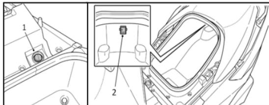
La luz del compartimento del casco o baúl se enciende cuando se levanta el asiento y se apaga cuando se cierra. La luz del compartimento del casco se activa con un sistema sensible a la luz exterior (1); en el caso de que el usuario se olvide cerrar el asiento o falle el cierre del asiento, el sistema cortará el suministro eléctrico pasado un tiempo preestablecido, evitando la descarga de la batería.
