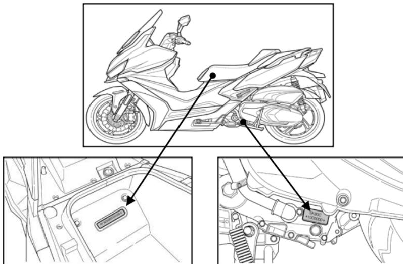
El número del chasis (VIN) está en el bastidor y se puede ver en la parte interior del baúl.
