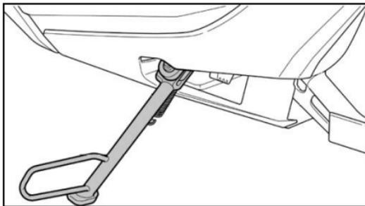
**ADVERTENCIA:** El interruptor del soporte lateral forma parte del circuito que corta el encendido; el usuario debe recoger el soporte lateral antes de iniciar la marcha. Si esta funcionalidad está inactiva, diríjase a un CSA para su reparación.
