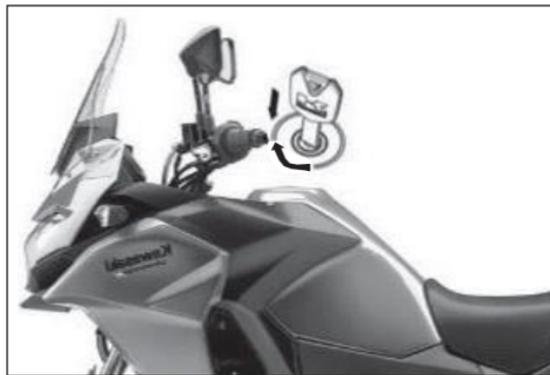
Para abrir la tapa del tanque inserte la llave en la tapa y gírela a la derecha.
