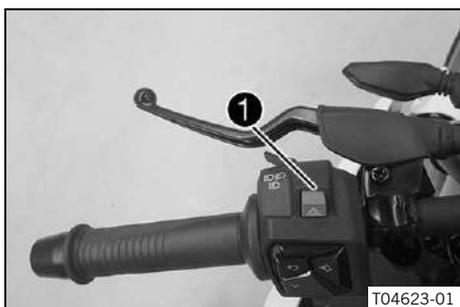
El interruptor de las luces de emergencia **1** se encuentra en el interruptor combinado superior. Las luces de emergencia se utilizan para señalar situaciones de emergencia.
