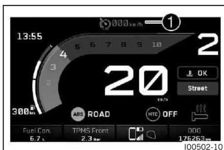
El estado de servicio del limitador de velocidad activado se muestra en la zona ❶ del display.
