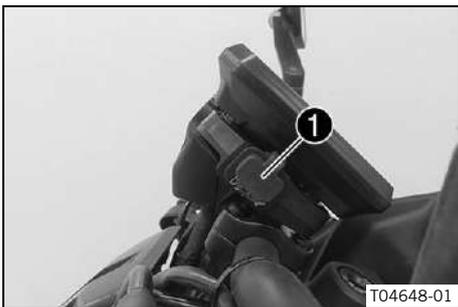
El conector USB ❶ para la alimentación de tensión de dispositivos externos se encuentra en la parte izquierda del soporte de la cubierta.
