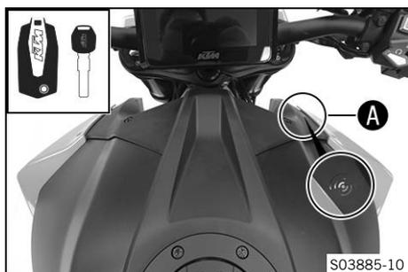
En este vehículo se sustituye la cerradura de encendido y del manillar por una llave a distancia con transpondedor (llave RACE-ON (📖 pág. 23)).
