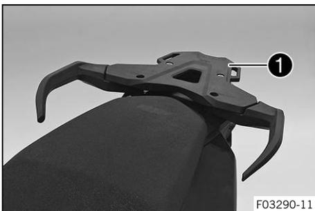
La placa portaequipaje ① se encuentra detrás del asiento. La placa portaequipaje permite fijar la placa de montaje de un sistema de maleta (opcional). La placa portaequipaje no se puede cargar con más peso del indicado.
