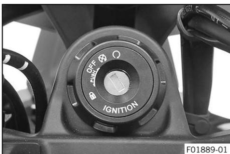
La cerradura de encendido y del manillar se encuentra delante de la tija superior de la horquilla.
