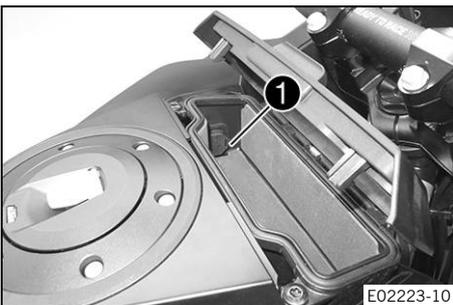
En el compartimento de almacenamiento se incluye un conector USB **1** para la alimentación de tensión de dispositivos externos.
