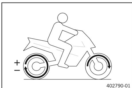
El control antiderrapaje es una función del control de tracción de la motocicleta.
