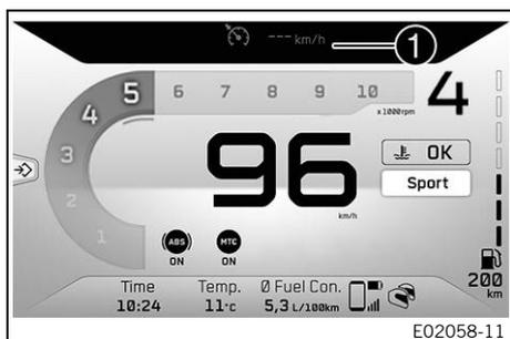
El estado de servicio del control de crucero activado se muestra en la zona **1** de la pantalla digital.
