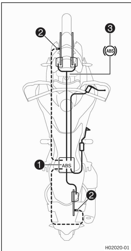
El módulo del ABS **1**, compuesto por una unidad hidráulica, una centralita electrónica del ABS y una bomba de recirculación, está instalado debajo del asiento. Hay un sensor de número de revoluciones de la rueda **2** tanto en la rueda delantera como en la trasera.
