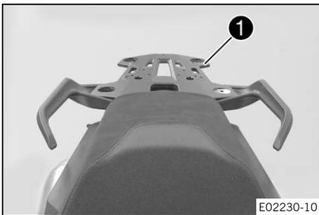
La placa portaequipaje ❶ se encuentra detrás del asiento. En la placa portaequipaje permite instalar la placa base de un cofre (opcional). La placa portaequipaje no se puede cargar con más peso del especificado.
