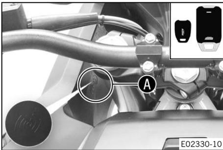
En este vehículo se sustituye la cerradura de contacto y bloqueo de dirección por una llave a distancia con transpondedor (llave de RACE ON (📖 pág. 23)).
