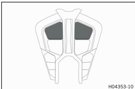
La luz de cruce está integrada en el faro principal. La luz de cruce se enciende cuando se conecta el encendido. Después de 5 segundos, la luz de cruce de vuelve a apagar si no se arranca el motor para no gastar la batería de 12 V. Si durante la conducción se desconecta involuntariamente el encendido, la luz de cruce permanece encendida.
