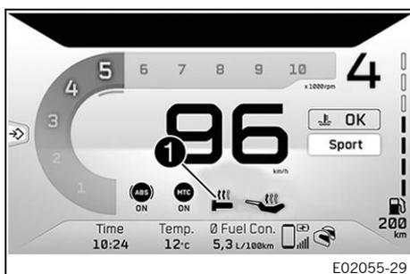
El estado del calefactor para puño se muestra en la zona **1** de la pantalla digital.
