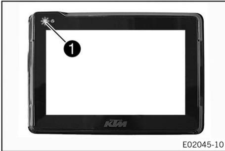
El testigo de RACE ON **1** puede indicar anomalías en su funcionamiento mediante parpadeos. Estos se emiten hasta cinco segundos después de pulsar el botón de RACE ON.
