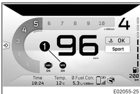
En la zona **1** de la pantalla digital se indica si **MTC** está conectado o desconectado.
