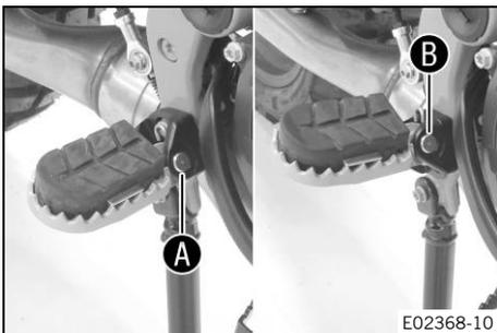
Los reposapiés del conductor se pueden montar en dos posiciones.
