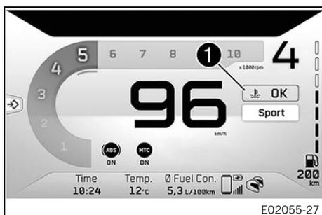
La temperatura del líquido refrigerante se muestra en la zona **1** de la pantalla digital.
