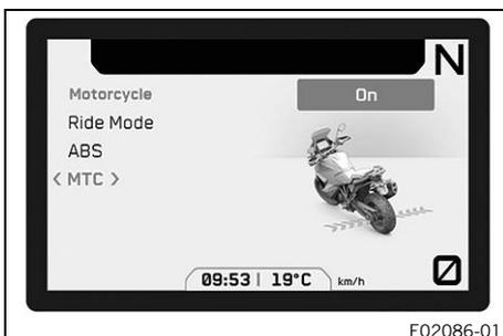
El control de tracción de la motocicleta (**MTC**) reduce el par motor en caso de pérdida de tracción en la rueda trasera. En función del modo de conducción (📖 pág. 153), con el control de tracción activado se permite una cantidad diferente de deslizamiento.
