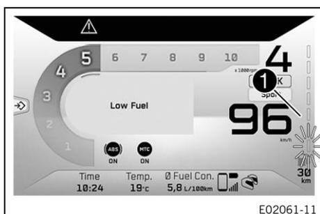
La capacidad del depósito de gasolina se muestra en la zona **1** de la pantalla digital.
