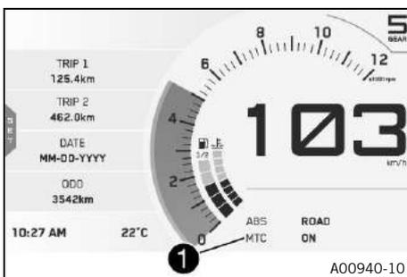
En la zona ① del display se indica si **MTC** está conectado o desconectado.
