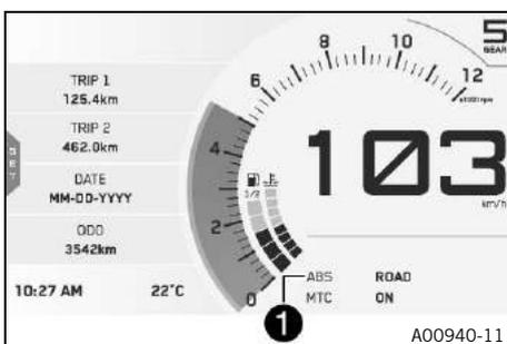
El modo de ABS ajustado se muestra en la zona ① de la pantalla digital.
