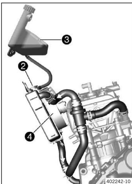
La refrigeración tiene lugar por medio de la corriente de aire y de un ventilador del radiador ④ que se conecta en función de la temperatura.
