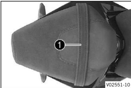
El acompañante puede utilizar el lazo agarradero **1** para sujetarse durante la conducción.
