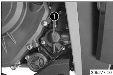
La bomba de agua ① del motor hace circular de manera forzada el líquido refrigerante.
