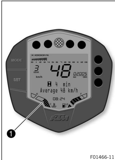
El indicador de la temperatura del refrigerante se muestra en la zona **1** del display.
