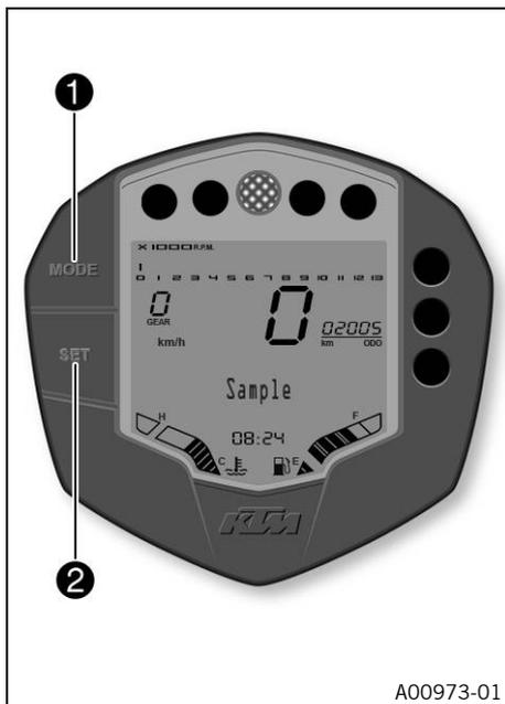
Con el botón **MODE** ① se cambian los modos de visualizado. Los posibles modos de visualizado son **ODO Menü** (datos de conducción generales), **Time Trip 1** (datos de conducción 1), **Time Trip 2** (datos de conducción 2), **ABS Mode Menu** (función ABS seleccionada), **Info Menu** (advertencias).
