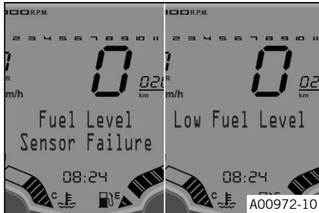
**Fuel Level Sensor Failure** aparece en el display cuando el sensor de nivel de combustible tiene un fallo.
