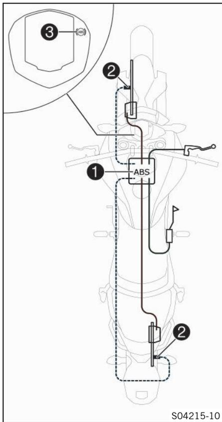
El módulo del ABS **1**, compuesto por la unidad hidráulica, la centralita electrónica del ABS y la bomba de recirculación, está instalado debajo del depósito. Hay un sensor de número de revoluciones de la rueda **2** en cada una de las ruedas, la delantera y la trasera.
