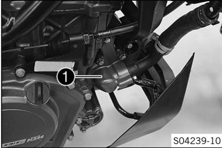
La bomba de agua ❶ del motor hace circular de manera forzada el líquido refrigerante.
