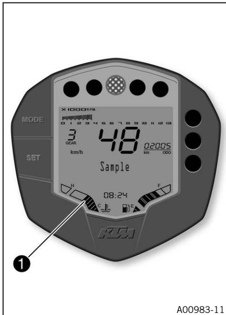
El indicador de la temperatura del refrigerante se muestra en la zona ❶ del display.
