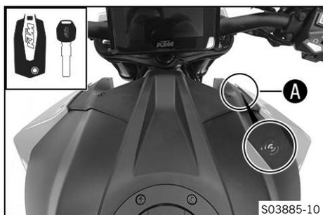
En este vehículo se sustituye la cerradura de encendido y del manillar por una llave a distancia con transpondedor (llave RACE-ON (📖 pág. 24)).
