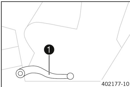
El pedal del freno ❶ se encuentra delante del reposapiés del lado derecho.
