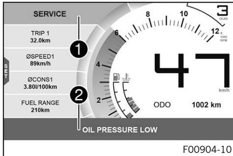
Las advertencias se muestran en el margen superior o inferior del display; en función de la relevancia se resaltan en amarillo o rojo. Las advertencias amarillas ❶ indican fallos o información que requieren tomar medidas rápidamente o adaptar el estilo de conducción.
