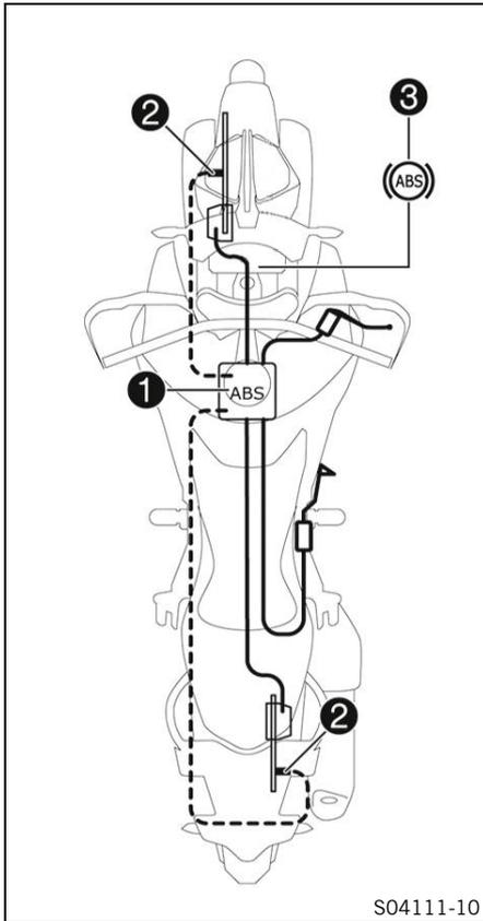
La unidad del **ABS** ①, compuesta por una unidad hidráulica, una centralita electrónica del ABS y una bomba de recirculación, está instalada debajo del depósito de combustible. Hay un sensor de número de revoluciones de la rueda ② en cada una de las ruedas, la delantera y la trasera.
