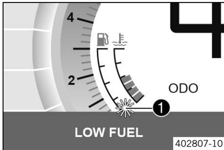
La capacidad del depósito de combustible se muestra en la zona ❶ del display.
