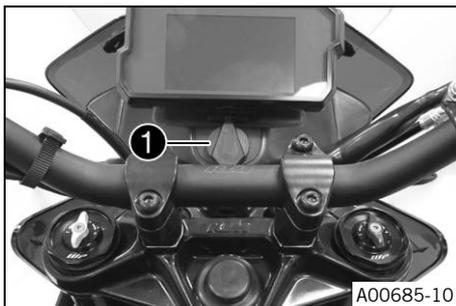
La toma de corriente ❶ de accesorios eléctricos se encuentra delante de la tija superior de la horquilla. Está conectada al positivo de encendido y protegida con un fusible.
