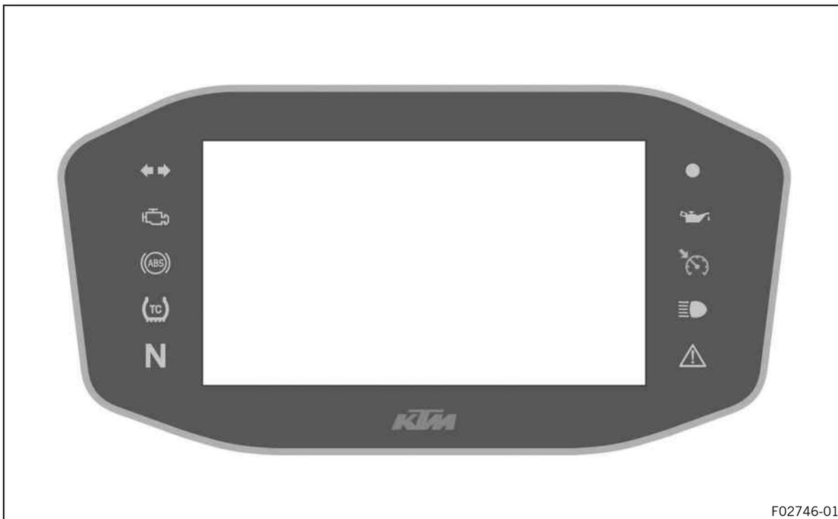
Los testigos de control proporcionan información adicional sobre el estado de servicio de la motocicleta. Al conectar el encendido, se iluminan brevemente todos los testigos de control.
