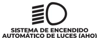
Sistema diseñado para que una vez se ponga el motor en marcha, la luz principal de la farola se encienda automáticamente. Este sistema garantiza una mayor visibilidad del vehículo para los demás actores viales.
