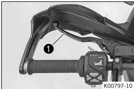
La maneta del embrague **1** se encuentra en el lado izquierdo del manillar. El embrague se acciona por vía hidráulica, y se reajusta automáticamente.
