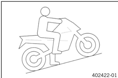
El **HHC** es una función adicional opcional del sistema de frenado. El **HHC** impide que la motocicleta ruede hacia atrás en subidas. El **HHC** reconoce las paradas en subidas y acciona el freno de la rueda trasera.
