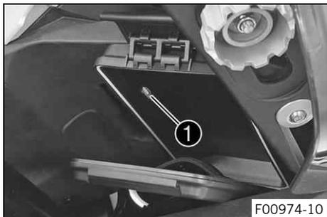
En el compartimento de almacenamiento se incluye un conector USB ① para la alimentación de tensión de dispositivos externos. El conector USB se activa junto con el encendido.
