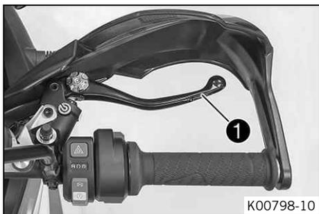
La maneta del freno de mano **1** se encuentra en el lado derecho del manillar. La maneta del freno de mano acciona simultáneamente el freno de la rueda delantera y el freno trasero.
