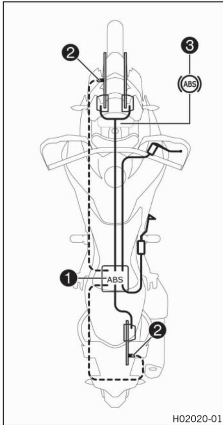
El módulo del ABS ①, compuesto por una unidad hidráulica, una centralita electrónica del ABS y una bomba de recirculación, está instalado debajo del asiento. Hay un sensor de número de revoluciones de la rueda ② en cada una de las ruedas, la delantera y la trasera.
