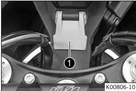
La toma de corriente ① de accesorios eléctricos se encuentra delante de la tija superior de la horquilla. Está conectada al positivo continuo y protegida con un fusible.
