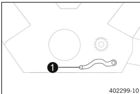
El pedal del cambio ❶ está montado en el lado izquierdo del motor.
