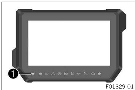
El testigo de control Race-on **1** puede indicar errores parpadeando. Estos se emiten hasta cinco segundos después de pulsar el botón Race-on.
