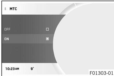
El control de tracción de la motocicleta (MTC) reduce el par motor en caso de pérdida de tracción en la rueda trasera. No obstante, algunos ajustes del control de tracción de la motocicleta requieren un ligero deslizamiento en la rueda trasera. Por ejemplo: Offroad.
