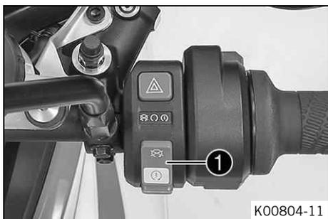
El interruptor de parada de emergencia/botón del motor de arranque **1** se encuentra en el interruptor combinado derecho.
