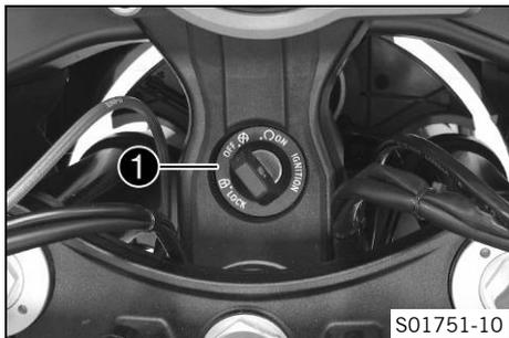
La cerradura de encendido y del manillar **1** se encuentra delante de la tija superior de la horquilla.
