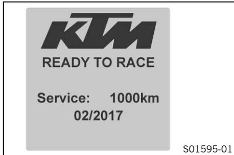
Después de conectar el encendido se visualiza brevemente el símbolo de mantenimiento.
