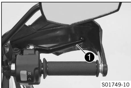
La maneta del freno de mano **1** se encuentra en el lado derecho del manillar. La maneta del freno de mano permite accionar el freno de la rueda delantera.
