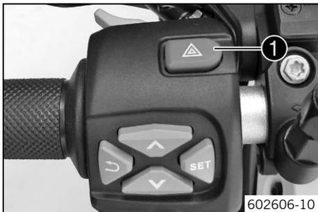
El interruptor de las luces de emergencia **1** se encuentra en el interruptor combinado izquierdo. Las luces de emergencia se utilizan para señalar situaciones de emergencia.
