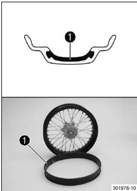
En este vehículo se utiliza un sistema de neumáticos sin cámara en el cual la cámara de aire convencional se sustituye por una goma de sellado de las llantas **1**.
