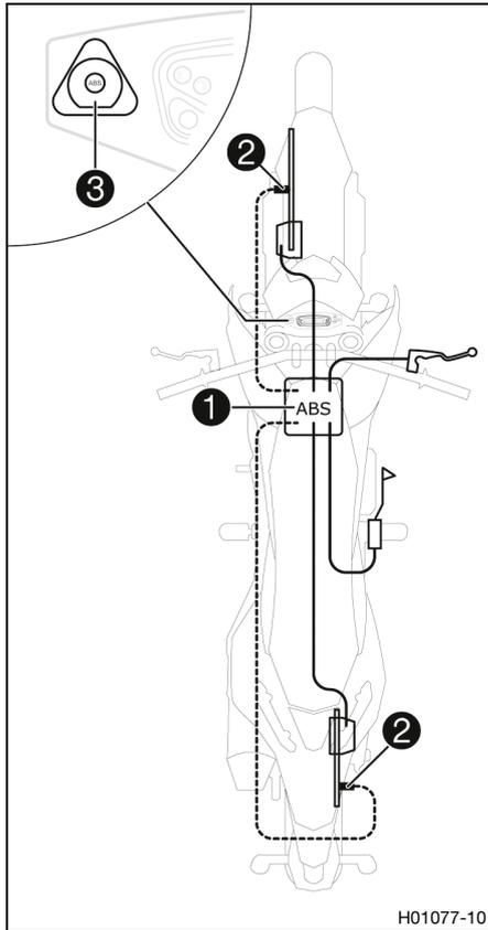
La unidad del ABS ①, compuesta por una unidad hidráulica, una unidad de mando del ABS y una bomba de recirculación, está instalada debajo del asiento. Hay un sensor de número de revoluciones de la rueda ② en cada una de las ruedas: la delantera y la trasera.
