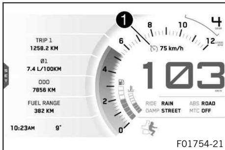
El estado de servicio del regulador de velocidad activado se muestra en la zona ❶ del display.
