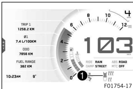
Si la calefacción del asiento está conectada, se muestra el símbolo **Heated Seat** en la zona ❶ del display. La calefacción del asiento se puede configurar en el menú **Heated Seat**.
