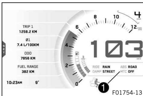
En la zona ❶ del display se indica si **MTC** está conectado o desconectado. En el menú **MTC** puede conectarse o desconectarse el control de tracción de la motocicleta.
