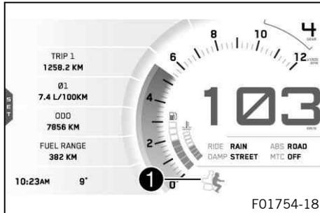
La carga ajustada se muestra en la zona ① del display.
