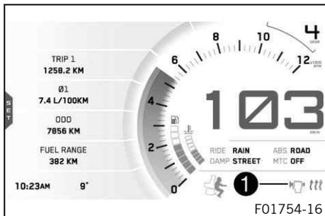
Si la calefacción de las empuñaduras está conectada, se muestra el símbolo **Heated Grips** en la zona ❶ del display. La calefacción de las empuñaduras se puede configurar en el menú **Heated Grips**.
