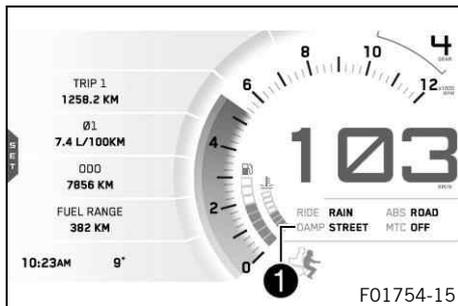
El modo **Damping** ajustado se muestra en la zona ❶ del display.
