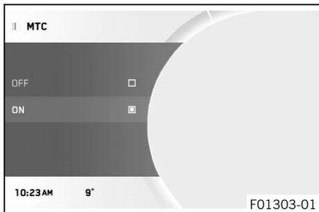
El control de tracción de la motocicleta (MTC) reduce el par motor en caso de pérdida de tracción en la rueda trasera. No obstante, para algunos ajustes del control de tracción de la motocicleta resulta favorable un ligero deslizamiento en la rueda trasera. Por ejemplo: Offroad.
