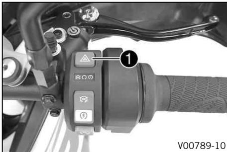
El interruptor de las luces de emergencia ❶ se encuentra en el interruptor combinado derecho. Las luces de emergencia se utilizan para señalar situaciones de emergencia.
