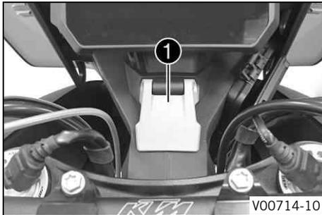
La toma de corriente ❶ de accesorios eléctricos se encuentra delante de la tija superior de la horquilla. Está conectada al positivo continuo y protegida con un fusible.
