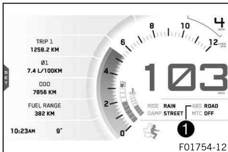
El modo de ABS ajustado se muestra en la zona ❶ del display. En el menú **ABS** puede configurarse el **ABS**.
