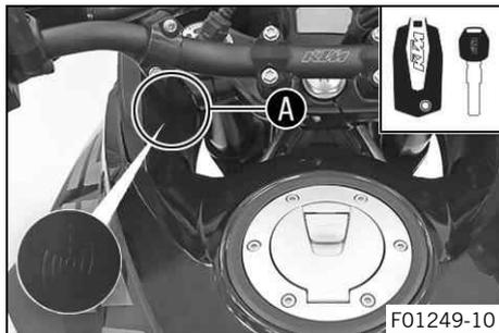
En este vehículo se sustituye la cerradura de encendido y del manillar por una llave a distancia con transpondedor (llave Race-on (📄 pág. 46)).
