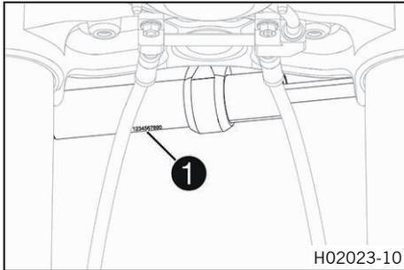
El número de artículo del amortiguador de la dirección **1** está grabado en la parte inferior del amortiguador de la dirección.
