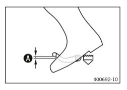
Montarse en el vehículo en posición de marcha y determinar la distancia entre el borde superior de la bota y el pedal de cambio.
