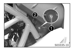
Girar el tornillo de ajuste 1 en sentido horario hasta que se note la última muesca con un destornillador.
