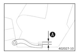
Mover el pedal del freno de un lado a otro entre el tope final y el punto de contacto con el émbolo del cilindro del freno trasero, y controlar el recorrido en vacío A.
