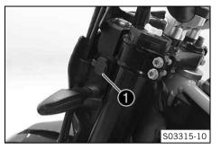
En la cubierta del faro izquierda se incluye un conector USB **1** para la alimentación de tensión de dispositivos externos. El conector USB se activa junto con el encendido.
