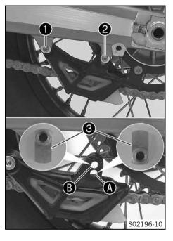
Soltar los tornillos 1 y 2. Desmontar la guía de la cadena.
