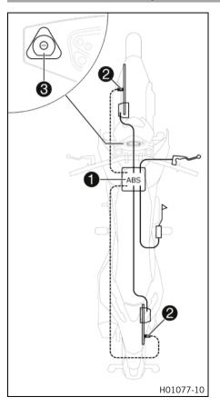
La unidad del <u>ABS</u> 1, compuesta por una unidad hidráulica, una centralita electrónica del ABS y una bomba de recirculación, está instalada debajo del asiento. Hay un sensor de número de revoluciones de la rueda 2 en cada una de las ruedas: la delantera y la trasera.
