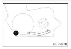
El pedal de cambio 1 está montado a la izquierda del motor.
