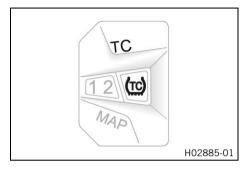
El control de tracción de la motocicleta (MTC) reduce el par motor en caso de pérdida de tracción en la rueda trasera.
