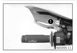
Adaptar la posición básica de la maneta del embrague al tamaño de la mano con el tornillo de ajuste 1.
