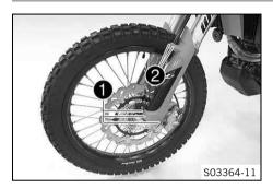
Posicionar el protector izquierdo de la horquilla. Montar y apretar los tornillos 1.
