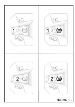
El interruptor combinado indica el ajuste actual del modo de conducción y el control de tracción.
