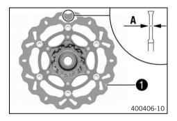
Comprobar la cota de espesor A en la parte delantera y trasera de los discos de freno, en varios puntos del disco de freno.
