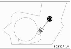
Retirar el tornillo de llenado de aceite con la junta tórica y agregar aceite del motor.
