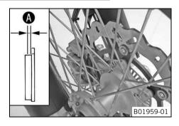
Controlar el espesor mínimo de las pastillas de freno A.
