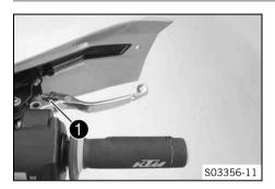
Adaptar la posición básica de la maneta del freno de mano al tamaño de la mano utilizando la rueda de ajuste 1.
