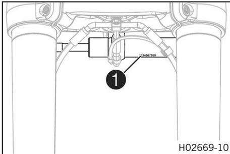
El número de artículo del amortiguador de la dirección ❶ está grabado en la parte inferior del amortiguador de la dirección.
