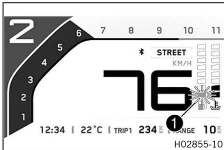
El indicador del nivel de combustible **1** está compuesto por barras. Cuantas más barras estén iluminadas, mayor será el nivel de combustible en el depósito de combustible.
