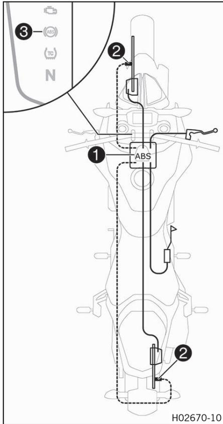
El módulo del ABS ①, compuesto por una unidad hidráulica, una unidad de mando del ABS y una bomba de recirculación, está instalado debajo del depósito de combustible. Hay un sensor de número de revoluciones de la rueda ② en cada una de las ruedas, la delantera y la trasera.
