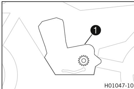
El número del motor **1** está grabado en la parte superior de la carcasa del motor.
