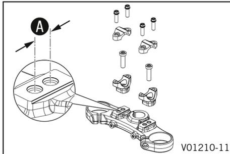
En la tija superior de la horquilla hay dos orificios separados entre sí a una distancia **A**.
