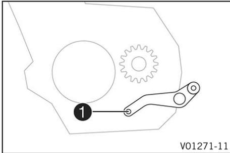
El pedal del cambio **1** está montado en el lado izquierdo del motor.
