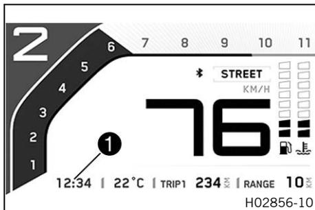
En todos los idiomas, excepto en EN-US, se muestra la hora **1** en formato de 24 horas. La hora **1** se muestra en formato de 12 horas si está configurado el idioma EN-US. En el menú **Clock/Date** puede configurarse la hora.
