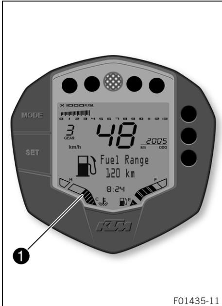
El indicador de la temperatura del refrigerante se muestra en la zona ❶ del display.
