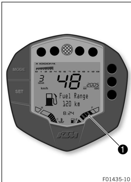
La capacidad del depósito de combustible se muestra en la zona ① del display.
