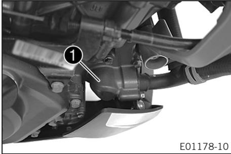
La bomba de agua **1** del motor hace circular de manera forzada el líquido refrigerante.
