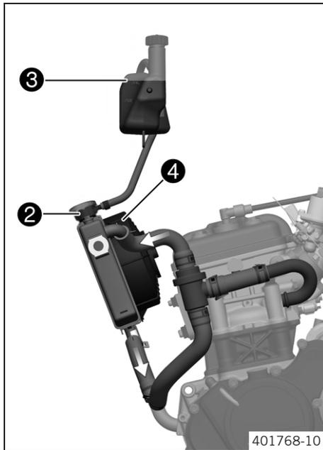
La refrigeración depende de la corriente de aire y de un ventilador del radiador ④ que se enciende a altas temperaturas. Cuanto menor sea la velocidad, menor es la acción refrigerante. La suciedad en los nervios del radiador reduce asimismo la acción refrigerante.
