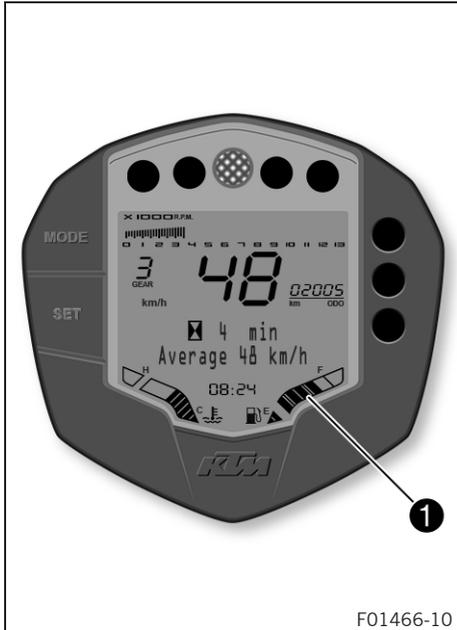
La capacidad del depósito de combustible se muestra en la zona ❶ del display.
