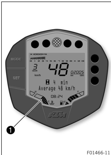
El indicador de la temperatura del refrigerante se muestra en la zona ① del display.
