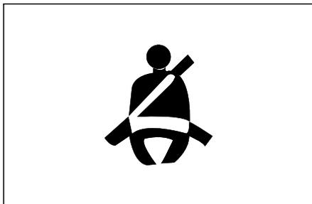
En caso de encender el vehículo sin utilizar el cinturón de seguridad o en caso de que el cinturón no esté sujetado al conducir, el sistema alertará al conductor y el testigo continuará parpadeando. El testigo y la alarma se apagarán únicamente cuando el conductor y los pasajeros sujeten sus cinturones.
