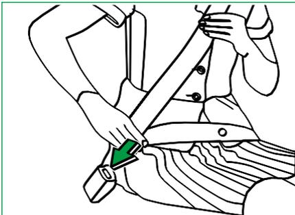
Para abrochar el cinturón de seguridad, saque el cinturón del retractor e introduzca el perno de resorte en la hebilla hasta que oiga un "clic", lo que significa que el
