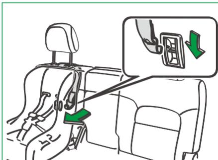
3. Fije el cinturón de seguridad en el punto fijo correspondiente y tenga cuidado de no doblarlo. Al fijarlo, asegúrese de que el cinturón de seguridad pase por debajo del reposacabezas del asiento.
