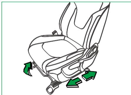
Mantenga levantada la palanca que se encuentra debajo de la parte delantera del asiento para desbloquearlo.
