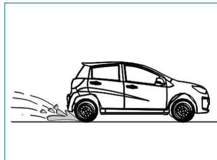
Cuando se conduce con nieve o lluvia, el sistema de sensor de marcha atrás puede sufrir de un fallo de alerta. Si está seguro de que su sistema presenta un problema que no sea ninguno de los anteriores, póngase en contacto con el servicio de posventa autorizado JAC para hacer el mantenimiento correspondiente.
