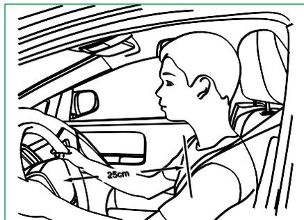
1. Ajuste el volante: La distancia entre el volante y el pecho no debe ser menor a 25 cm.
