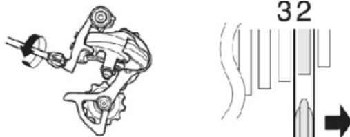
Una vez que la palanca de cambios levanta la holgura del cable de cambio, teóricamente la cadena rozará contra el tercer volante y emitirá un sonido.
