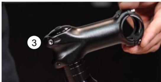
12. Retire los tornillos que aseguran la sujeción frontal del manubrio (4) en la espiga, esto usando una llave Allen 5mm
