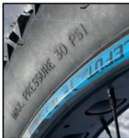
Las presiones máximas y mínimas permitidas de los neumáticos se pueden encontrar en el costado del neumático
