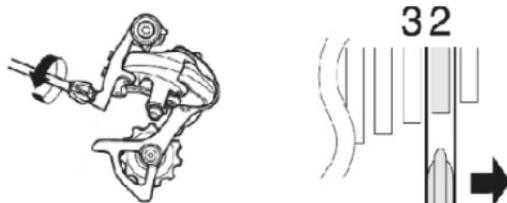
Una vez que la palanca de cambios levanta la holgura del cable de cambio, teóricamente la cadena rozará contra el tercer volante y emitirá un sonido.
