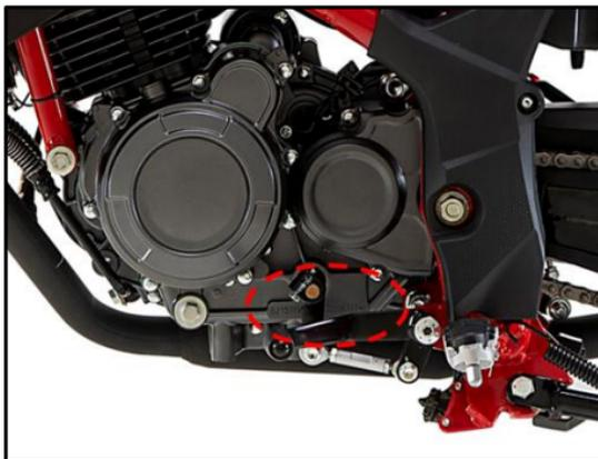
El número del motor se encuentra ubicado en la parte inferior de la carcasa izquierda del motor.
