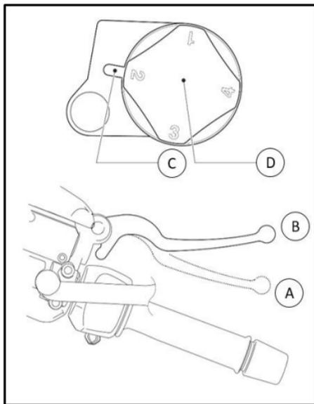
**Ajuste de la leva de clutch:** El juego libre del clutch se mide desde el punto libre de la leva de clutch, hasta el punto de acople del clutch, el estándar debe de ser de 10 – 20 mm.
