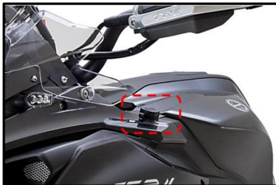
**Nota:** Use el toma de carga USB solamente para la carga de la batería del teléfono móvil. El uso de otros dispositivos electrónicos puede causar daños en el sistema eléctrico.
