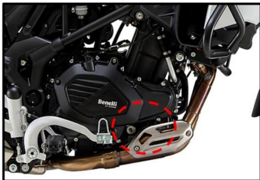
El número del motor se encuentra ubicado en la parte inferior de la carcasa derecha del motor.
