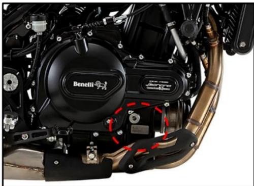
El número del motor se encuentra ubicado en la parte inferior de la carcasa derecha del motor.
