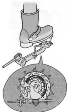
No maneje con el pie siempre sobre el pedal de freno trasero, esto recalienta las bandas de freno y pone amarilla la campana trasera.
