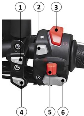
**1. BOTÓN ATRÁS (↶):** Permite volver atrás, cuando se encuentre en el modo de ajuste de funciones del tablero.
