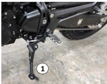
**ADVERTENCIA:** El interruptor del soporte lateral forma parte del circuito que corta el encendido; el usuario debe recoger el soporte lateral antes de iniciar la marcha. Si esta funcionalidad está inactiva, diríjase a un CSA para su reparación.
