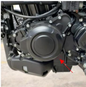
El número del motor se encuentra ubicado en la parte inferior de la carcasa izquierda del motor.
