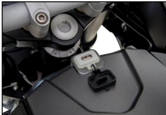
**Nota:** Use el toma de carga USB solamente para la carga de la batería del teléfono móvil. El uso de otros dispositivos electrónicos puede causar daños en el sistema eléctrico.
