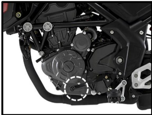
El número del motor se encuentra ubicado en la parte inferior de la carcasa izquierda del motor.
