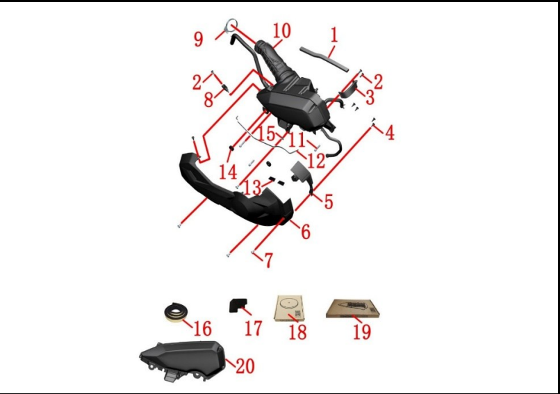
FIGURA N° 79:CAJA FILTRO AIRE
