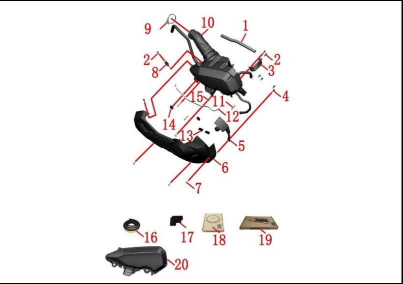
FIGURA N° 79:CAJA FILTRO AIRE
