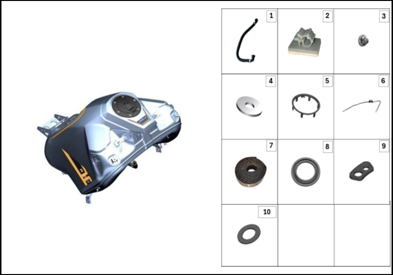
FIGURA N° 39: COMPLEMENTO TANQUE COMBUSTIBLE
