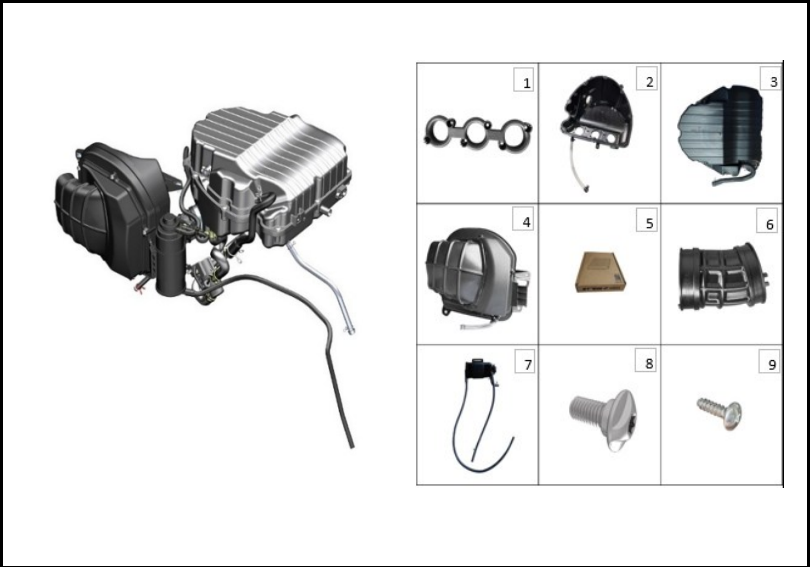
FIGURA N° 96: CAJA FILTRO AIRE
