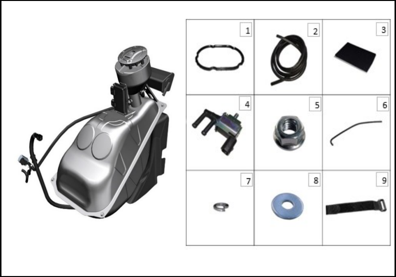
FIGURA N° 101: COMPLEMENTO TANQUE COMBUSTIBLE
