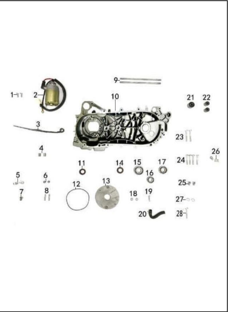
FIGURA N° 5: CARCASA MOTOR IZQUIERDA - MOTOR DE ARRANQUE (1/2)
