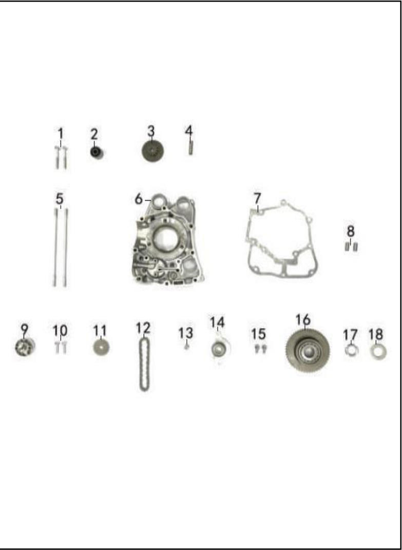
FIGURA N° 4: CARCASA MOTOR DERECHA - BOMBA ACEITE
