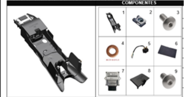
FIGURA 30: CAJA DISPOSITIVOS ELECTRICOS
