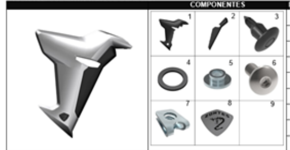
FIGURA 22: CUBIERTA TANQUE DERECHA
