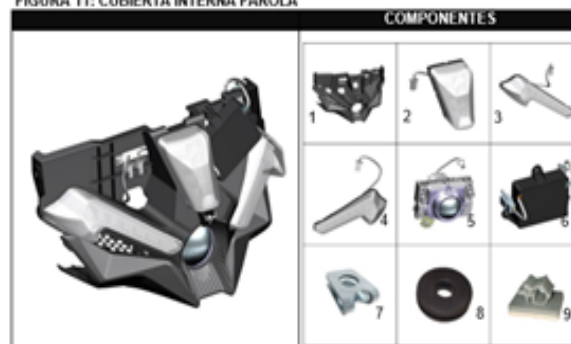
FIGURA 11: CUBIERTA INTERNA FAROLA
