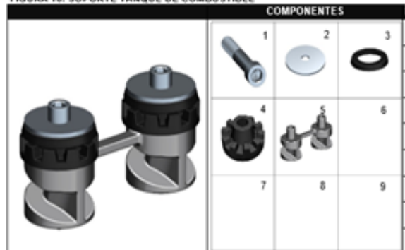
FIGURA 16: SOPORTE TANQUE DE COMBUSTIBLE
