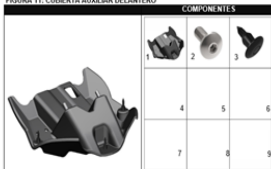
FIGURA 11: CUBIERTA AUXILIAR DELANTERO
