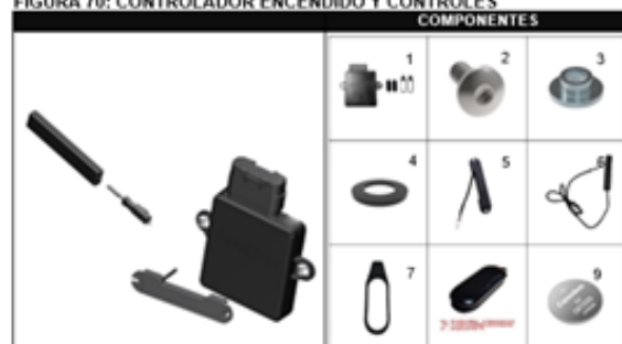
FIGURA 70: CONTROLADOR ENCENDIDO Y CONTROLES
